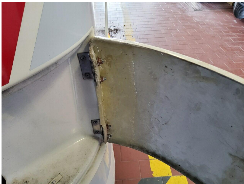
Bild 13 : Tankdeckel, unsachgemäÙe Reparatur
