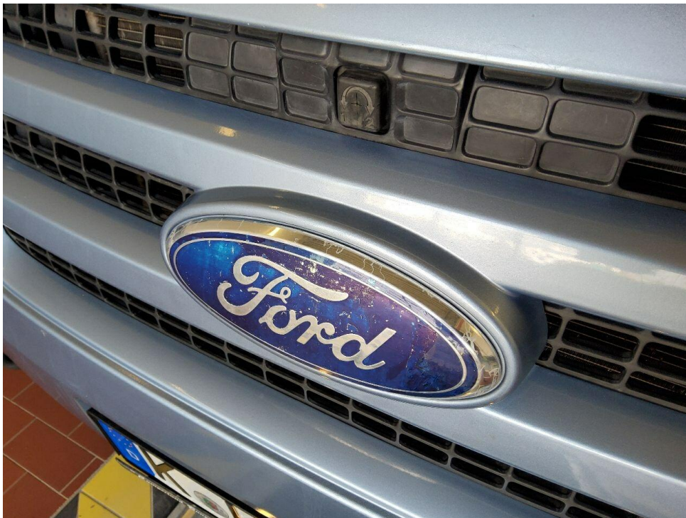
Bild 24 : Fordemblem am Kühlergrill rissig
