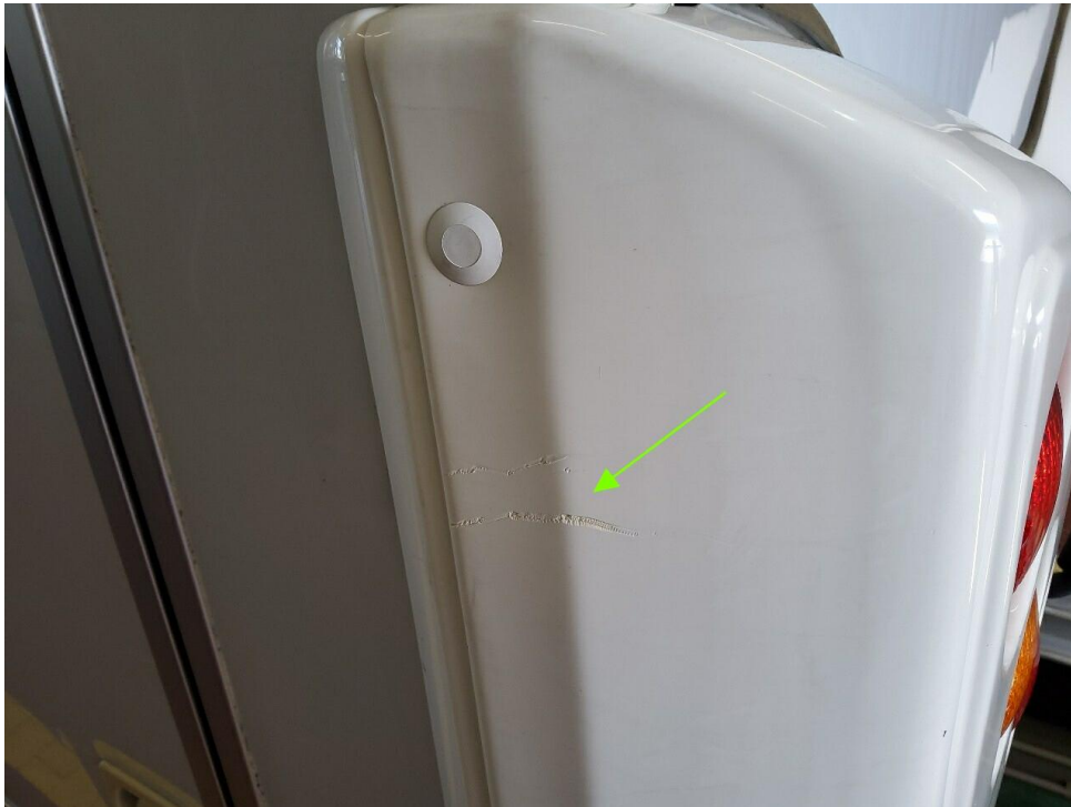
Bild 19 : Stoßfänger hinten zerkratzt
