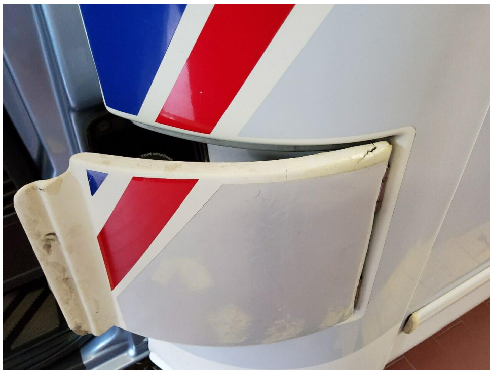
Bild 12 : Tankdeckel, unsachgemäÙe Reparatur
